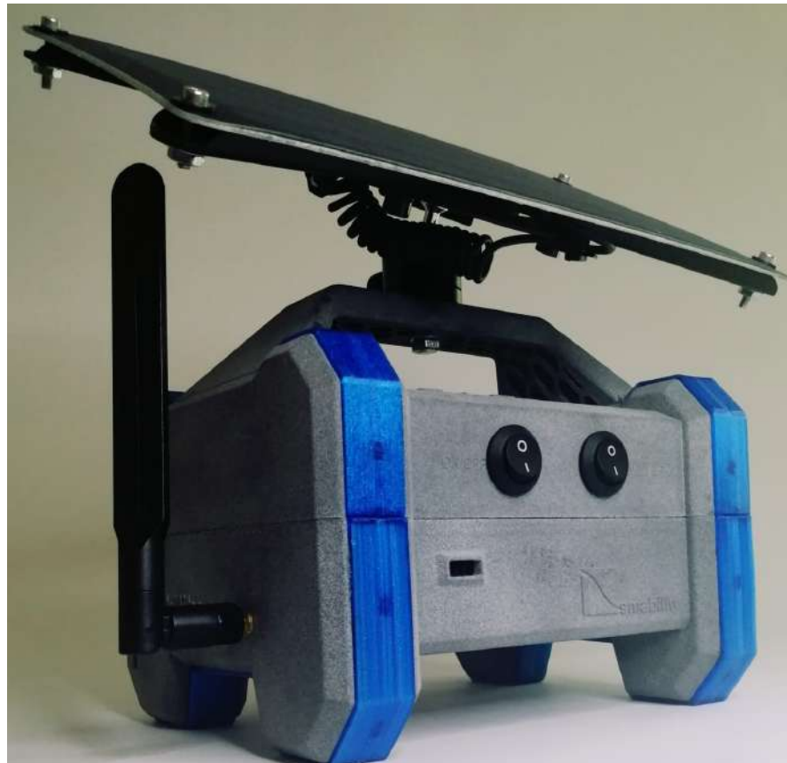
Dispositivo basado en microsensores nacionales para medir la calidad del aire
